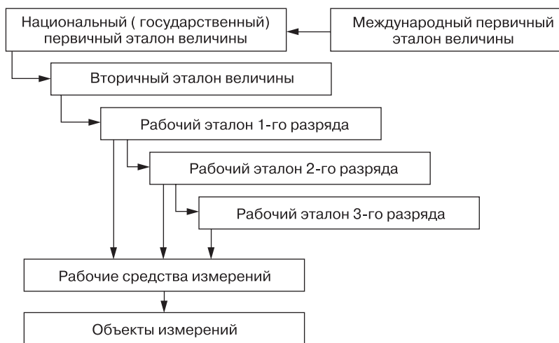
Рис. 15.2.1. Система передачи размера единицы величины
